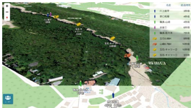
位置情報管理システムにより重機や作業員の位置を可視化
