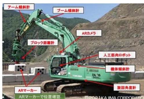
自動化施工使用のバックホウの概要
