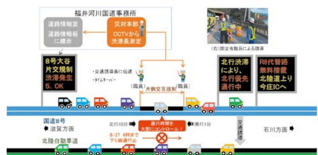
片側交互通行規制箇所の交通コントロール
