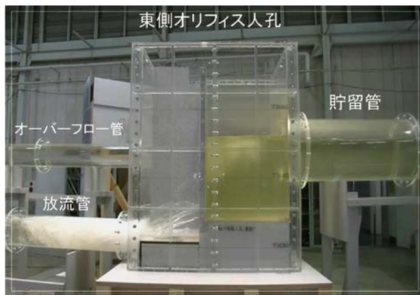
流量制御施設の水利模型実験状況
